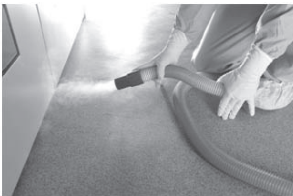
รูปที่ 3 แสดงช่องว่างใต้ประตูเข้าห้องแยกเดี่ยวผู้ป่วยสูงไม่เกิน 1/2 นิ้ว และการใช้เครื่องวัดแรงดันต่าง หรือ การใช้เครื่องสร้างควัน (Aerosol Generator) เพื่อทดสอบทิศทางการไหลของกระแสลม
